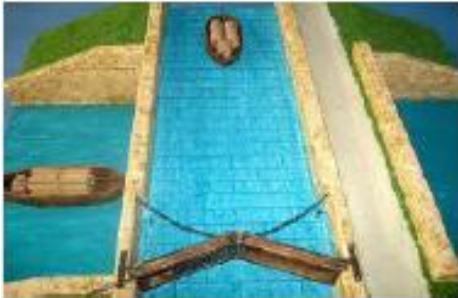
La conca inizia a svuotarsi dall'acqua attraverso l'apertura dei portelli inferiori
