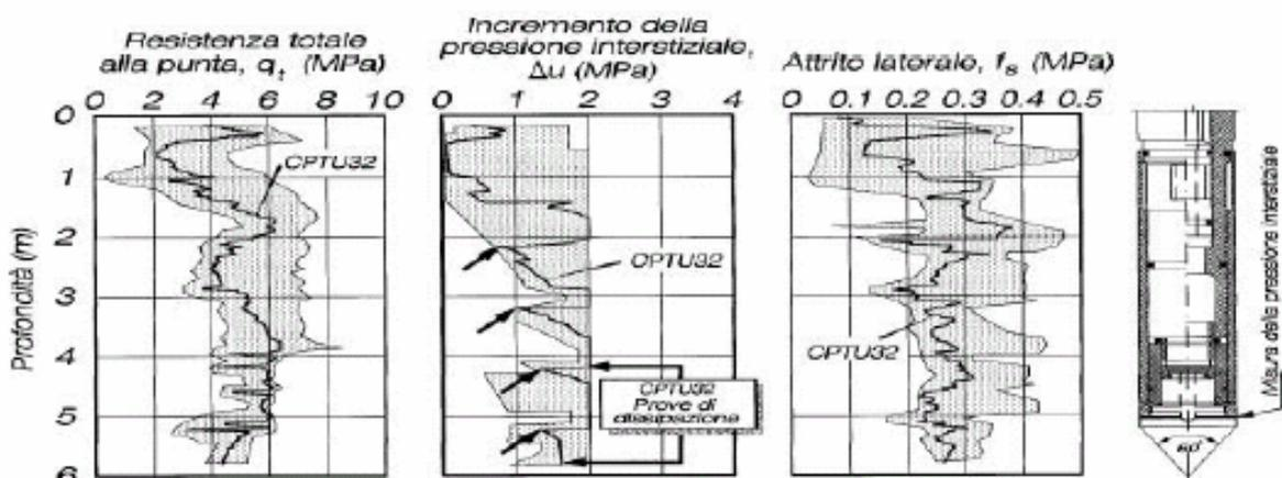
Figura 21: Esempio di risultati di prove CPTU eseguite (Manassero, 1994)
