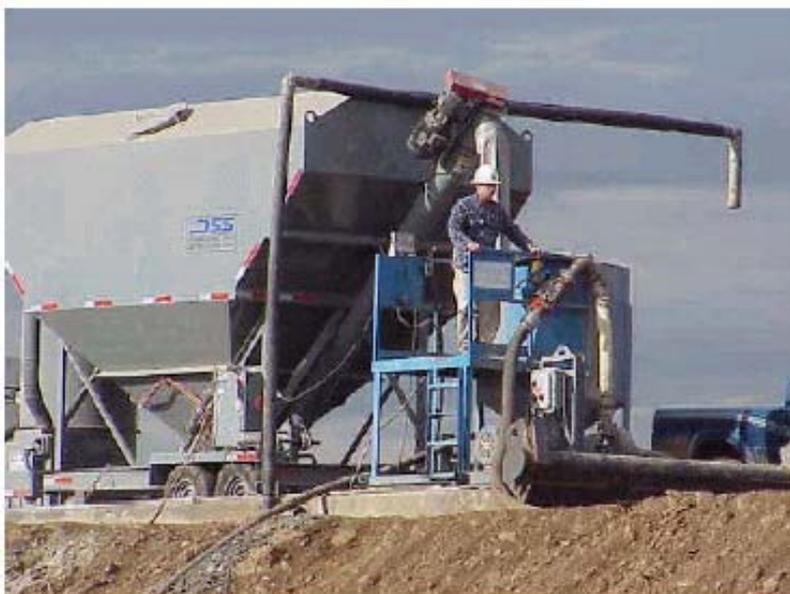
Figura 19: impianto di produzione della miscela plastica.
